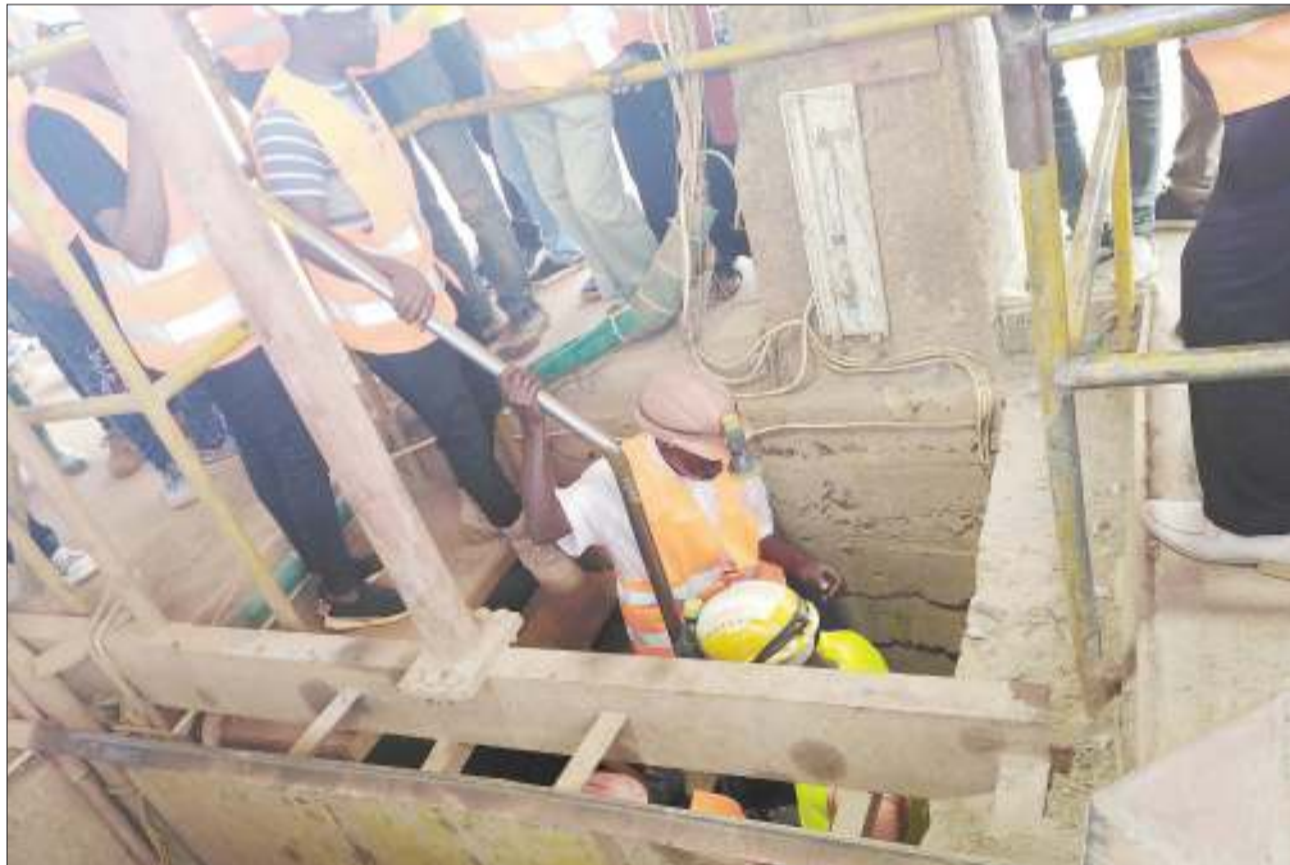
Wachimbaji wadogo wa migodi ya Msasa Nyarugusu na Nyakagwe, wakiingia kwenye mgodi wa mfano wa Nsangano, mkoani Geita hivi karibuni, ambao umejengwa kwa zege tofauti na mazoea ya wachimbaji wadogo wanaotumia magogo ambayo huhatarisha usalama wao na kuharibu mazingira. PICHA: MPIGAPICHA WETU
