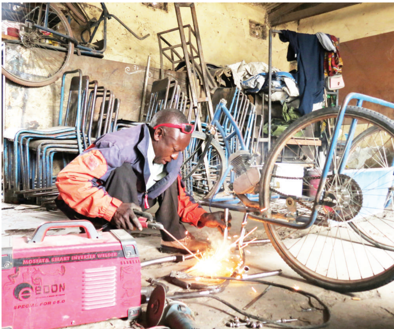
Mjasiriamali Mwita Marwa ambaye ni mlemavu wa miguu akichomelea mabomba kwa ajili ya kuitengeneza baiskeli inayotumiwa na watu wenye ulemavu kwenye karakana yake, katika stendi ya Sabasaba, jijini Dodoma juzi. PICHA: PETER MKWAVILA
